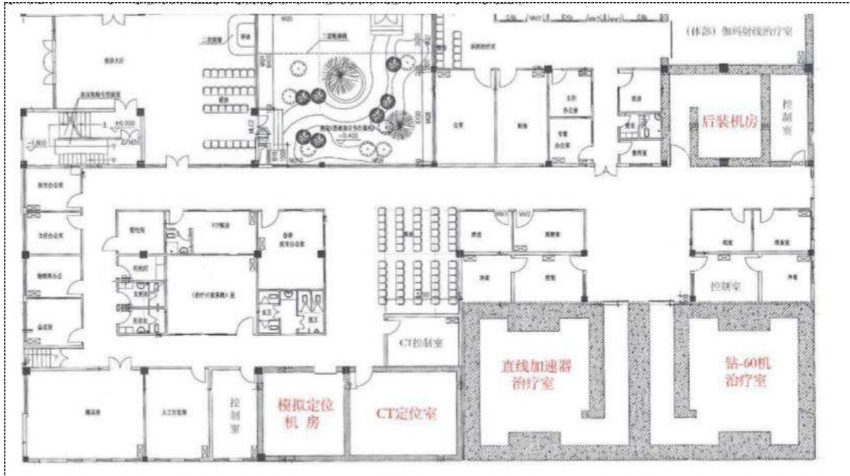
图 1-3 钴-60 治疗机项目的主机机房所在楼层平面图
