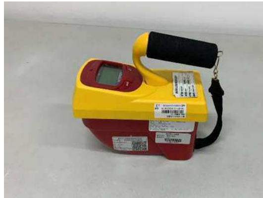
图 3-12 451P 型环境级 X、 \gamma 辐射测量仪
